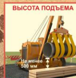
ЛЕЖКИ ПОД ТРУБОПРОВОД
