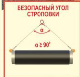
СТРОПОВКА ТРУБ УДАВКОЙ
