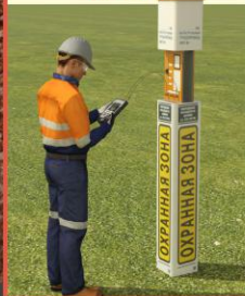
ПРОВЕРКА ПАРАМЕТРОВ ЭХЗ НА КИП
