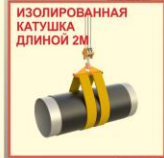
СТРОПОВКА ТРУБ УДАВКОЙ
