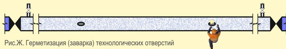
Рис.Ж. Герметизация (заварка) технологических отверстий
