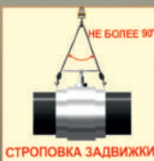
СТРОПОВКА ЗАДВИЖКИ
