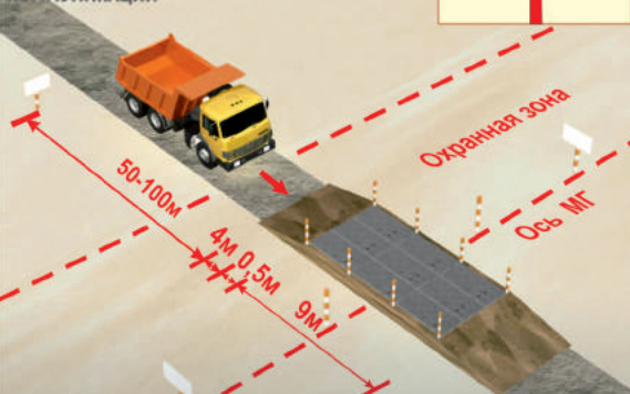
Поперечный разрез переезда через МГ
