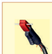
ИСПОЛЬЗОВАНИЕ ЭЛЕКТРОДОУДЕРЖАТЕЛЕЙ С НАРУШЕННОЙ ИЗОЛЯЦИЕЙ РУКОЯТКИ
