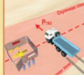
ПЕРЕЕЗД ТРАНСПОРТА ЧЕРЕЗ ТРУБОПРОВОД
